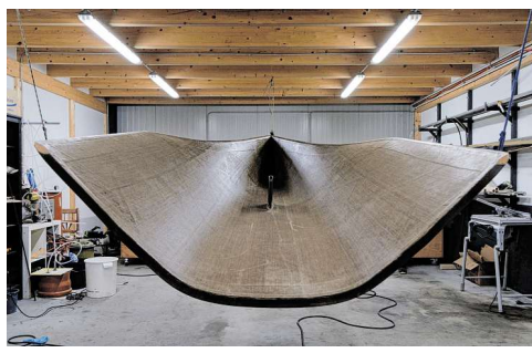
Im Laminierraum trocknet der Rumpf eines Segelbootes.
