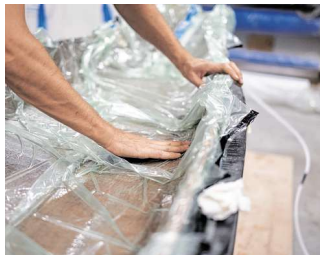
Das Vakuum sorgt dafür, dass Flachs und Harz in die Form gepresst werden.
