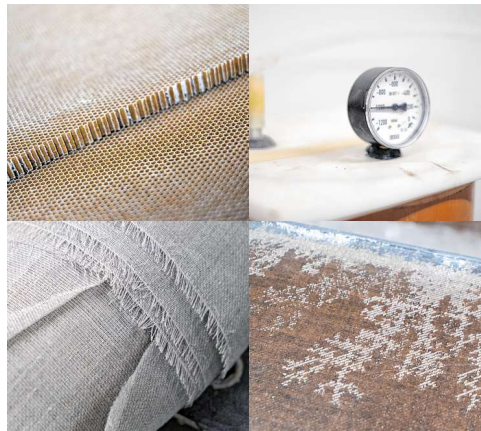
Die Boote bestehen aus Kork- oder Papierwaben (links oben) und Flachsfaser (links unten). Beim Vakuumisieren zeigt ein Messgerät den Druck an (rechts oben). Wird versehentlich Luft im Harz eingeschlossen, entstehen helle Flecken (rechts unten).
